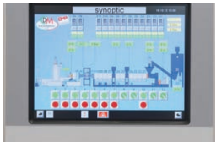
Touch Screen del PC industriale XP700 consente di visualizzare lo stato di ogni componente dell'estrusore, modificare parametri e prevenire i guasti
